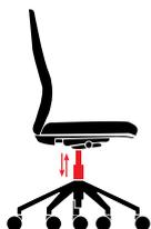
Las sillas deben disponer de una opción que permita subir o bajar la altura del asiento, ya sea mediante un sistema mecánico o un sistema neumático. Con ello se persigue que la postura sea la adecuada, teniendo los pies apoyados firmemente en el suelo y los muslos en posición horizontal. Además, el mecanismo debe ser fácilmente accesible desde una posición sentada.
